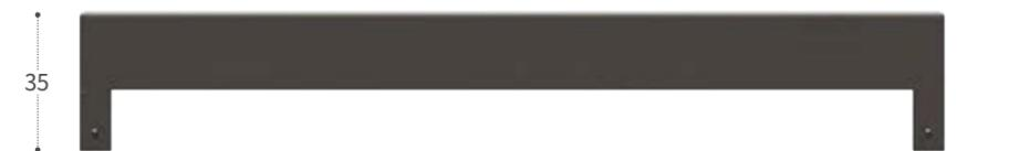
**ANTA POLO:** caratterizzata dal profilo sporgente su ambo i lati, monta cerniere senza molla e prevede chiusura mediante riscontro magnetico su base e coperchio.
